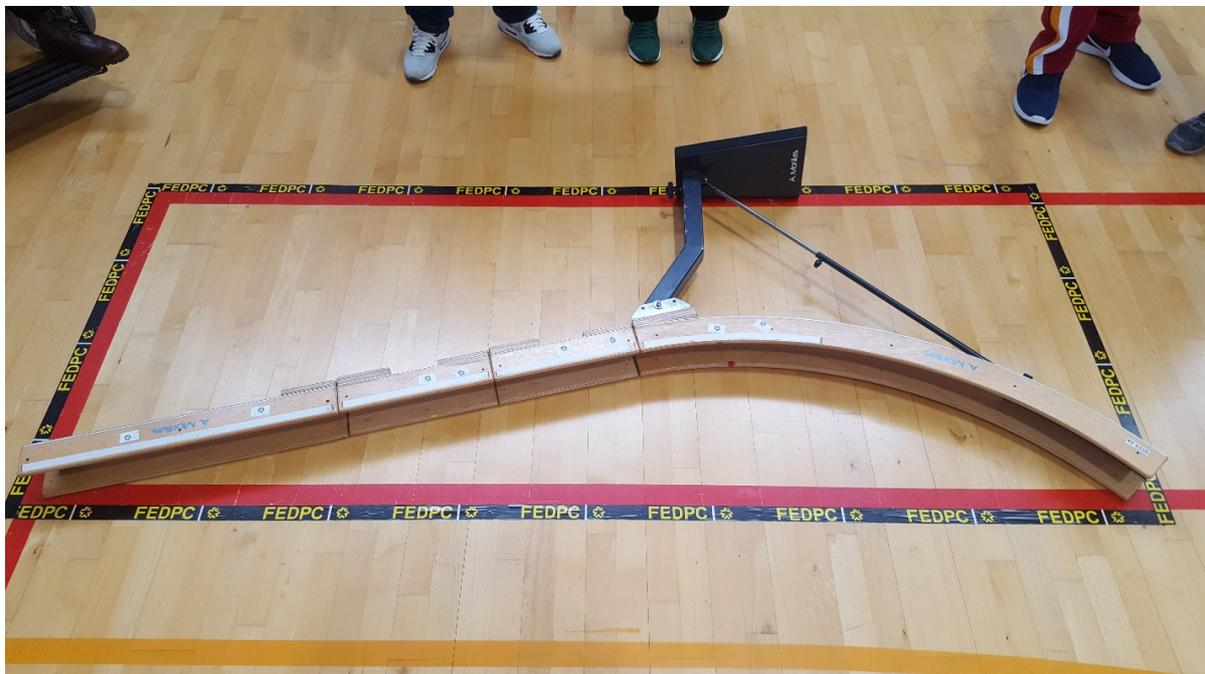
Photo n ° 2 Test du dispositif d'assistance : Cependant, lorsque la barre de support est en extension complète, comme indiqué dans la règle 5.1, la rampe n'est pas légale. La barre de support doit être coupée afin que la rampe ainsi que la barre de support en extension complète puisse entrer à l'intérieur de la boîte, ce qui la rendrait légale.
